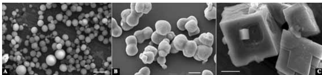
Figura 2. Strutture a base di carbonato di calcio utilizzate come stampi per dare forma alle nanocapsule. In funzione delle modalità di preparazione si possono ottenere forme sferiche (A), a nocciolina (B) o romboedriche (C).
